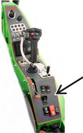
Alla brytare är placerade intill handgasspaken
