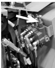
**Hidráulica Auxiliar:** La presión se ajusta desde la válvula de alivio detrás de la rueda izquierda delantera. Ajuste con el tornillo de cabeza hexagonal.
