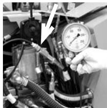
**Hidráulica auxiliar:** La presión se mide montando el manómetro en la unión rápida hembra de hidráulica auxiliar con plenas rev. y girando la palanca de control. La presión es de 185 bar.
