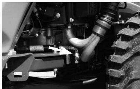
Utilice el tubo indicado en la foto para vaciar el aceite de motor.
