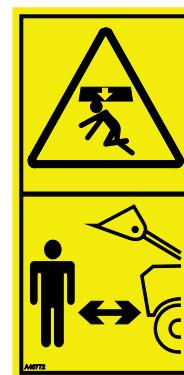
Pamäťajte si, že rameno nakladača sa môže spustiť alebo nakloniť, aj keď bol motor vypnutý (riziko rozdrvenia). Nakladač nie je určený na dlhšie držanie zdvihnutého bremena. Pred opustením sedadla vodiča vždy spusťte prídavné zariadenie do bezpečnej polohy.
