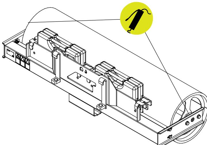
Limpe a extremidade do bocal antes de lubrificar e adicione apenas uma pequena quantidade de lubrificante de cada vez. Todos os bocais de lubrificação são bocais R1/8" padrão. Substitua quaisquer bocais danificados.
