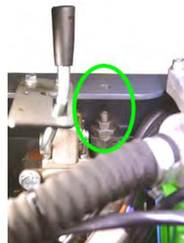
A pressão do sistema hidráulico auxiliar é ajustada a partir da válvula de alívio de pressão da válvula de controle hidráulica auxiliar.
