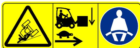
**AVISO:** Risco de capotamento - Mantenha as cargas próximas do chão, dirija devagar quando transportar cargas.
