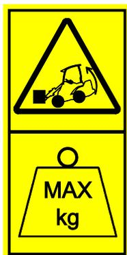
A elevada capacidade de carga do carregador possibilita exceder a estabilidade do carregador aquando do manuseamento de cargas. Leia as instruções relativamente à capacidade máxima de elevação e o manuseamento de carga neste Manual de Operador. Seguir as instruções reduz o risco de capotamento da máquina sobre o eixo dianteiro, mas o operador deverá ter consciência dos limites da máquina e seguir as práticas de trabalho seguras para evitar o capotamento da máquina.
