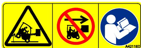
**AVISO:** Risco de capotamento (direção dianteira)- Mantenha a carga próxima do chão, dirija devagar.
