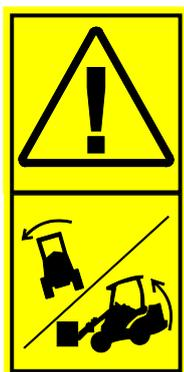
A estabilidade e a capacidade de manuseamento de carga do carregador são significativamente reduzidos em terrenos inclinados e a capacidade de elevação máxima podem ser atingidas apenas em terreno firme e nivelado. Em terreno horizontalmente inclinado a carga deverá ser mantida próxima do chão e nunca deve ser elevada no alto.
