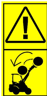
Certifique-se de que a carga está bem segura no acessório. Nunca dobre um acessório para trás quando estiver levantado. Opere apenas com máquinas equipadas com estruturas ROPS e FOPS.
