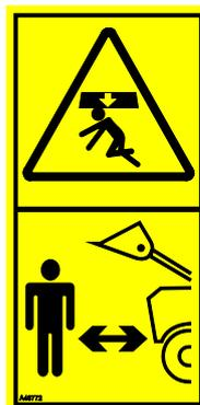
Lembre-se sempre que o propulsor poderá rebaixar inesperadamente devido a perda de estabilidade, avaria mecânica ou se outra pessoa operar os controlos do carregador, levando a perigo de esmagamento. O acessório ou o carregador não devem ser deixados com uma carga elevada durante longos períodos. Rebaixe o acessório antes de sair do assento do motorista. A estabilidade do carregador poderá mudar quando sair do assento do motorista, levando a uma dobragem da máquina.
