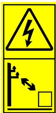
Perigo de choque elétrico - Contacto com ou trabalho muito próximo a cabos elétricos poderão resultar em choque elétrico letal. Mantenha o carregador, ou qualquer acessório, a uma distância suficiente de todos os cabos elétricos, ver tabela abaixo.
