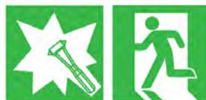
No caso de a abertura normal do lado esquerdo do carregador estar bloqueada, o pára-brisas pode ser utilizado como saída de emergência.
