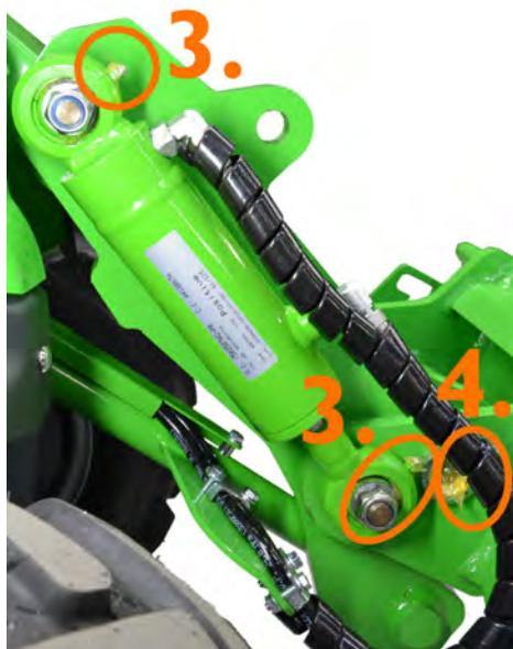
4. **Pino do pivô no propulsor/disco de acoplamento de acessório** 3
