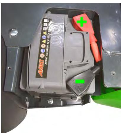
A bateria está selada e livre de manutenção, significando que não necessita e não pode ser reabastecida com água durante a sua vida útil. Não tente abrir a tampa da bateria.
