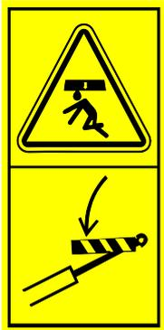
Segure sempre o propulsor do carregador com o suporte de serviço fornecido antes de se colocar debaixo do propulsor do carregador. Remova qualquer carga e acessórios do carregador antes do serviço ou da manutenção.
