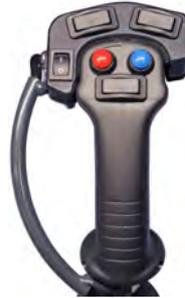
Se o seu carregador estiver equipado com o pacote de interruptor de controle de acessório opcional, as funções elétricas de um acessório pode ser controladas com os botões extra instalados no joystick.
