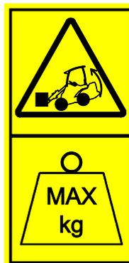
A capacidade de elevação do carregador é limitada pela possibilidade de capotamento em volta do eixo dianteiro.
