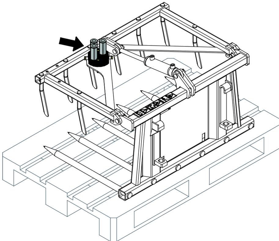
Para períodos de armazenamento mais longos, retoque a pintura onde necessário, lubrifique os pontos de lubrificação e oleie as partes visíveis do eixo do cilindro hidráulico para evitar danos devidos a ferrugem.
