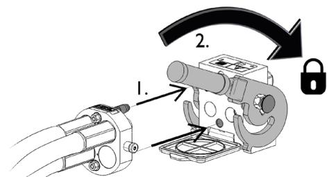
A alavanca deverá mover-se lentamente até à posição de bloqueio. Se a alavanca não deslizar com suavidade, verifique o alinhamento e a posição do conector e limpe os conectores. Desligue ainda o carregador e liberte a pressão hidráulica residual.
