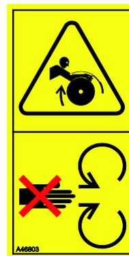
Evite bloquear a enxada rotativa ajustando a velocidade de condução de acordo com as condições operativas. Mantenha o equipamento limpo, para que o material não fique preso no mesmo.
