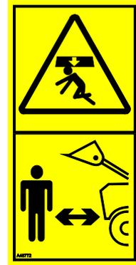
Nunca se esqueça que o propulsor do carregador poderá ser rebaixado ou dobrado mesmo se o motor estiver desligado (perigo de esmagamento). O carregador não deve ser utilizado para manter uma carga elevada durante longos períodos. Rebaixe sempre o acessório para uma posição segura antes de sair do assento do motorista.
