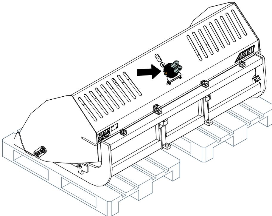
Limpe o acessório antes de longos períodos de armazenamento retoque a pintura sempre que necessário, lubrifique os pontos de lubrificação e coloque óleo nas partes visíveis dos eixos do cilindro hidráulico para evitar ferrugem.
