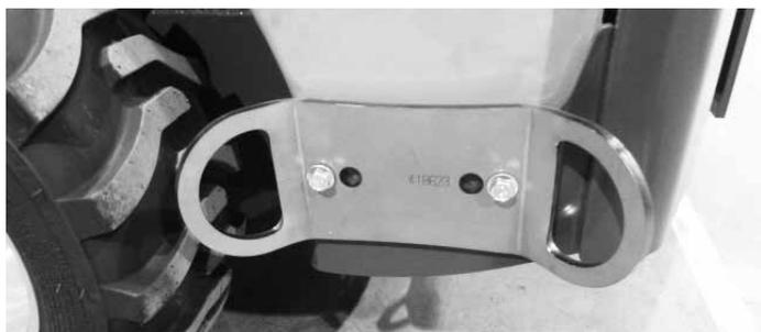
Suporte inferior A418623 instalado na lateral da estrutura traseira. São necessários dois suportes para instalação lateral.
