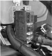
Na cabina DLX com fusíveis adicionais A/C localizam-se na caixa de fusíveis próximo da alavanca do acelerador, acessível através da remoção do painel da tampa do lado direito no exterior da cabina.
