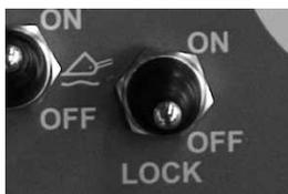
**DESBLOQUEAR:** Neste modo, o óleo hidráulico flui em séries de motor para motor. As rodas irão rodar com maior liberdade e o carregador deixa menos marcas em superfícies suaves.
