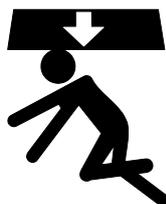
**Risco de esmagamento - Segure sempre o suporte de serviço do propulsor no cilindro de elevação do propulsor antes de se colocar debaixo do propulsor ou de qualquer acessório.**
