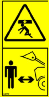
**A queda de carga ou o rebaixamento inesperado do propulsor do carregador - Risco de esmagamento.**
