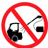
Nunca borrife o compartimento do motor ou os radiadores com uma máquina de pressão. Os radiadores de refrigeração, o equipamento elétrico, e os seus conectores e isoladores e a bateria poderão ficar danificados. Utilize água quente ou fresca para lavar outras partes do carregador. Nunca utilize água quente (acima de 70°C).
