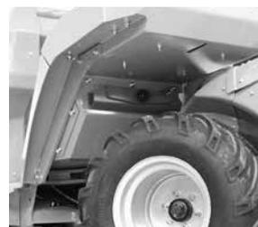
O bloqueio de estrutura localiza-se na junta da articulação, na base do assento, e é apertado com um parafuso.
