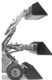
NOTA: A autonivelção é desativada quando a flutuação do propulsor é ligada.
