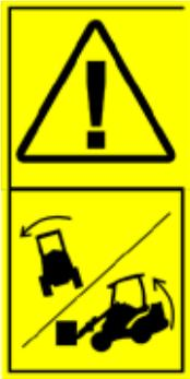
**Risco de capotamento - Mantenha sempre as cargas próximas do chão.** A estabilidade e a capacidade de manuseamento de carga do carregador são significativamente reduzidos em terrenos inclinados e a capacidade de elevação máxima podem ser atingidas apenas em terreno firme e nivelado. Em terreno horizontalmente inclinado a carga deverá ser mantida próxima do chão e nunca deve ser elevada no alto.
