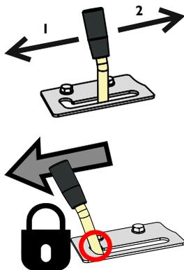
Pode utilizar esta alavanca ou os botões do joystick elétrico (equipamento opcional) para operar o acessório. Coloque a alavanca em sua posição neutra quando parar de utilizar o carregador.
