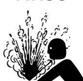
**Risco de queimadura de óleo hidráulico - Isole o acumulador hidráulico antes do serviço**
