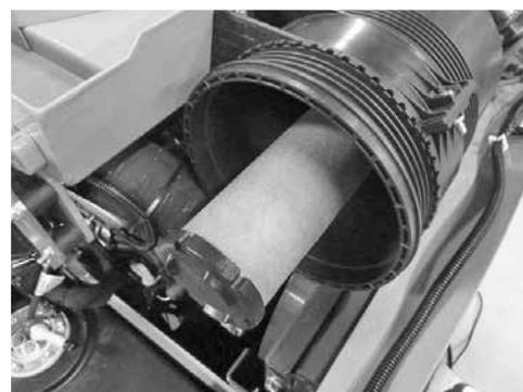
66061 Filtro de ar, elemento da tela interior (Substituir apenas quando necessário)
