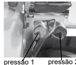
Se as saídas hidráulicas auxiliares extra forem instaladas na traseira do carregador, a saída é de tipo de ação dupla.
