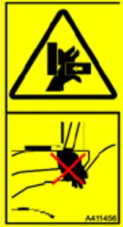
**Pontos de aperto** - Evite colocar-se entre a estrutura do carregador e entre o carregador e as paredes - Mantenha todas as partes do corpo dentro da estrutura de segurança. Os movimentos da estrutura articulada cria perigos de aperto. Mantenha a cabeça, as mãos e os pés dentro do carregador. Tenha um especial cuidado quando dirigir perto de paredes e árvores. Mantenha as mãos no volante e no joystick.
