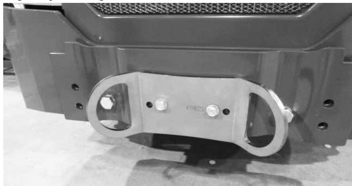
Suporte inferior A418623 instalado no para-choques traseiro ou no contrapeso
