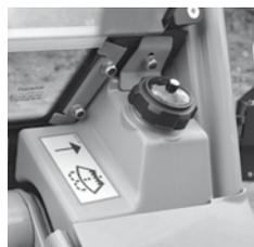
O depósito do limpa pára-brisas e a tampa de enchimento nas máquinas com cabina LX e DLX localizam-se fora da cabina, na dianteira do pára-brisas à esquerda.
