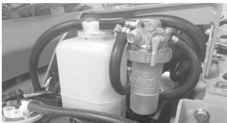
Nunca abra o radiador pressurizado, quando o motor estiver quente. O refrigerante quente poderá rebentar e causar queimaduras graves. Deixe que o motor arrefeça completamente antes de abrir.
