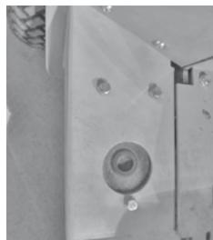
Nas máquinas com cabina L, o depósito localiza-se atrás da roda esquerda dianteira e a abertura de enchimento está no painel de pé.
