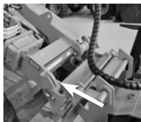
O suporte de serviço vermelho do cilindro do elevador do propulsor localiza-se na ponta do propulsor, atrás do disco de acoplamento de acessório.
