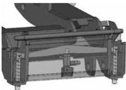
O disco de acoplamento do acessório hidráulico permite a conexão e a desconexão do acessório do assento do motorista. Existe um cilindro hidráulico no disco de acoplamento do acessório que movimenta os pinos de bloqueio para cima e para baixo. O sistema eletrohidráulico funciona também quando o motor não está a funcionar, desde que o interruptor de ignição esteja na posição "ON" (corrente ligada). O interruptor de controle localiza-se no painel de controle do lado direito (ver página 24).
