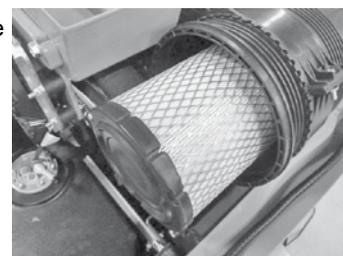
1. Aperte a entrada de borracha na tampa de revestimento do filtro para drenar água e sujidade do filtro.
