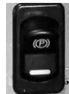
O freio de estacionamento engata automaticamente quando o motor está parado. O travão pode ser libertado apenas quando o motor estiver a funcionar e quando existir pressão hidráulica no sistema.
