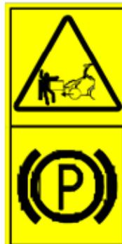
**Risco de esmagamento por carregador em movimento - Engate o freio de estacionamento antes de trabalhar próximo do carregador.**
