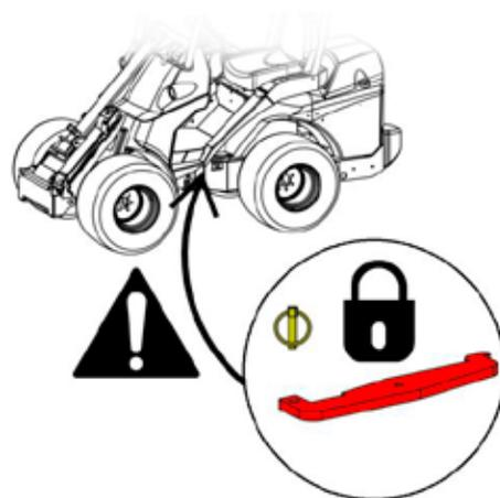
Bloqueie sempre o bloqueio de estrutura antes de transportar ou elevar o carregador. Lembre-se ainda de remover o bloqueio de estrutura e teste a direção do carregador após o transporte.
