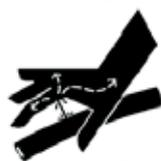
**Nunca manuseie os componentes hidráulicos se o sistema hidráulico estiver pressurizado - Risco de injeção de óleo hidráulico através da pele.**
