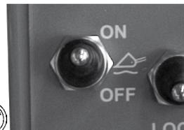
NOTA: O interruptor é instalado no painel de instrumentos, também em casos em que a opção de flutuação de propulsor não está instalada no carregador. A presença do interruptor não significa que as opções de propulsor flutuante ou de movimento suave sejam instaladas.
