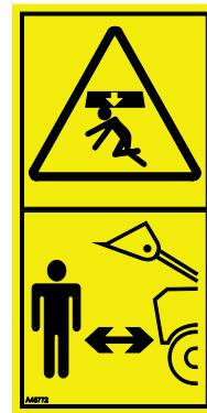
Husk at lasterbommen kan senkes eller tiltes, selv når motoren er slått av (klemfare). Lasteren skal ikke forlates for å holde en last løftet i lengre tid. Alltid senk redskapet ned til en trygg stilling før du forlater førersetet.
