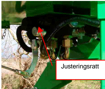
Fig 5.4 Ratt for justering av matevalser
