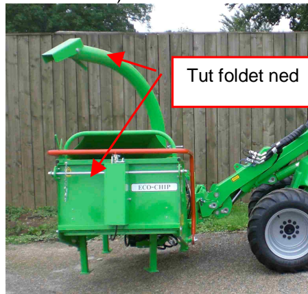
Fig 5.6 Tut klar for transport (untatt støttebeinene)
