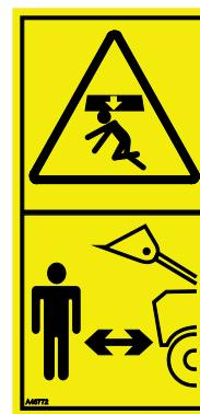
Husk at lasterbommen kan senkes eller tiltes, selv når motoren er slått av (klemfare). Lasteren skal ikke forlates før å holde en last løftet i lengre tid. Alltid senk redskapet ned til en trygg stilling før du forlater førersetet.
