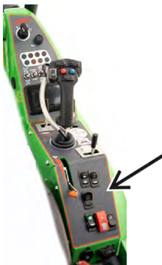
Alle schakelaars zitten bij de handgashendel
