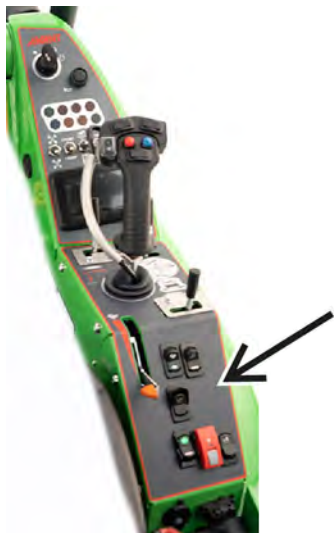
Alle schakelaars zitten bij de handgashendel
