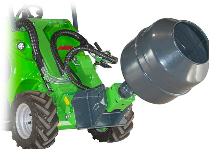
Ruotare la betoniera lentamente durante il riempimento iniziale. La corretta velocità di rotazione finale per il mescolamento varia in funzione del materiale mescolato. **La velocità di rotazione non deve mai superare un giro al secondo.**
