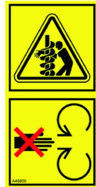
L'adattatore per pali a vite deve essere ruotato lentamente (utilizzato a bassi regimi motore).
