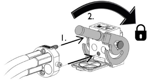
La leva deve potersi muovere facilmente fino alla posizione di bloccaggio. Se la leva non scorre in modo fluido, controllare l'allineamento e la posizione del connettore e pulire i connettori. Spegnere anche la pala caricatrice e rilasciare la pressione idraulica residua.
