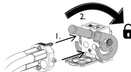
La leva deve potersi muovere facilmente fino alla posizione di bloccaggio. Se la leva non scorre in modo fluido, controllare l'allineamento e la posizione del connettore e pulire i connettori. Spegnere anche la pala caricatrice e rilasciare la pressione idraulica residua.
