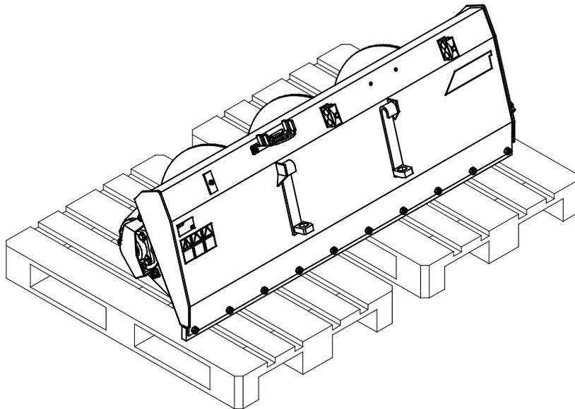
Per lunghi periodi di stoccaggio, ritoccare la vernice dove necessario e lubrificare i punti di lubrificazione per evitare danni da ruggine.
