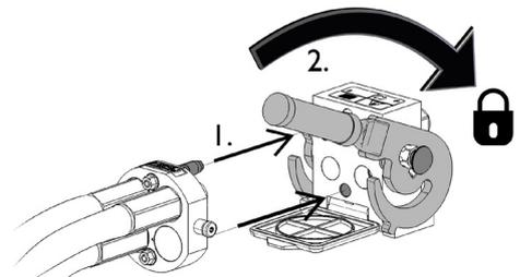
La leva deve potersi muovere facilmente fino alla posizione di bloccaggio. Se la leva non scorre in modo fluido, controllare l'allineamento e la posizione del connettore e pulire i connettori. Spegnerne anche la pala caricatrice e rilasciare la pressione idraulica residua.
