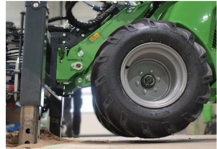
Quando si scava su superfici morbide è possibile montare una punta separata sugli stabilizzatori. La punta può essere regolata sotto lo stabilizzatore a due diverse lunghezze.
