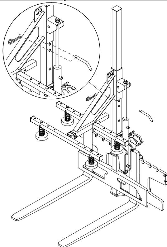
Retirez du mât la goupille de verrouillage (3) du chariot inférieur.
