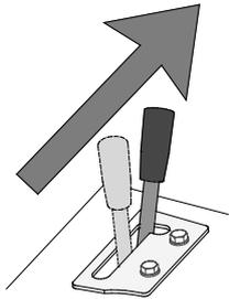
Actionnez le levier de commande du circuit hydraulique auxiliaire vers sa position de verrouillage (ou utilisez les boutons électriques du joystick électrique en option) pour fermer le grappin.
