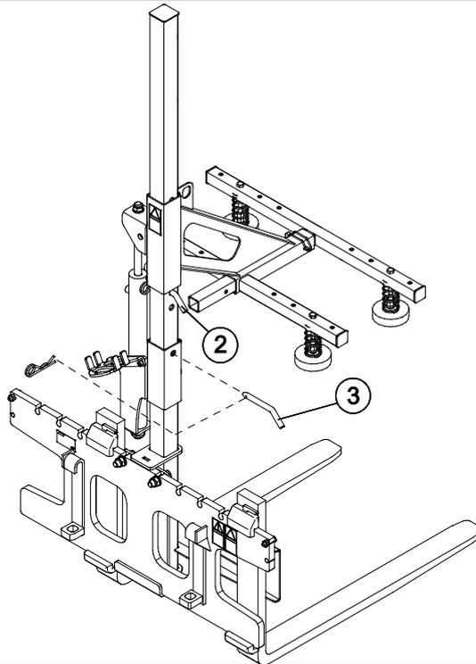
Le repositionnement du chariot inférieur vers le bas se fait par l'extension du vérin hydraulique.
