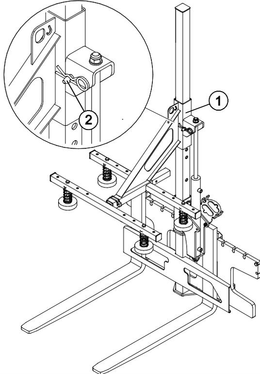
Installez la goupille de verrouillage dans le trou se trouvant dans le mât, tel qu'indiqué sur la figure adjacente, et abaissez le chariot supérieur sur la goupille.
