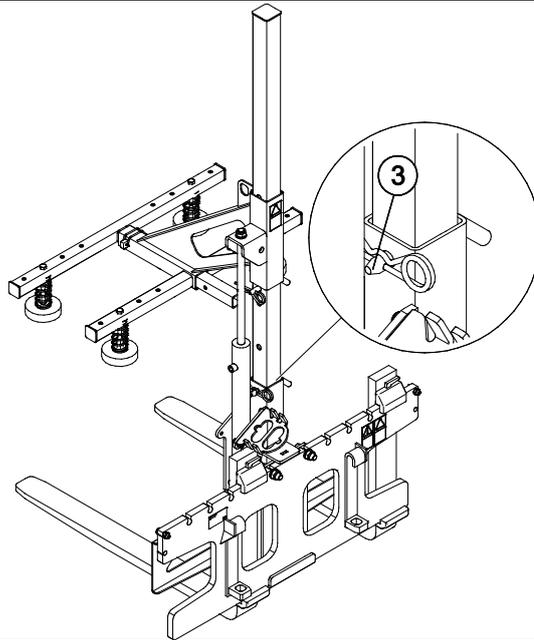
Tout d'abord, conduisez le chariot inférieur vers le haut. Puis, verrouillez le chariot à la hauteur souhaitée à l'aide de la goupille de verrouillage (3). Enfin, retirez la goupille de verrouillage (2) et remettez-la dans son support.
