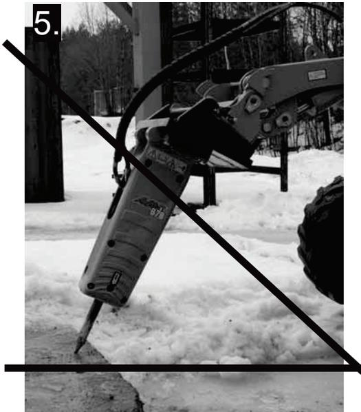
16. N'utilisez pas le marteau pour balayer les débris répandus sur le sol. Ceci risque de l'endommager et d'accélérer l'usure du boîtier.
