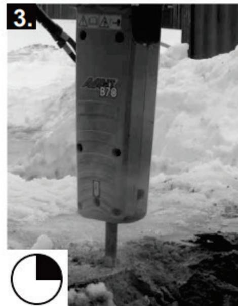
9. Ne frappez pas au même endroit plus de 15 secondes consécutives. Si l'objet ne se brise pas ou si l'outil ne pénètre pas, arrêtez le marteau et modifiez la position de l'outil. Un travail prolongé au même endroit engendre de la poussière de roche sous l'outil. Cette poussière amortit l'effet d'impact et dégage de la chaleur. (voir image 3).
