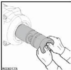
3. Déposez le joint de la douille inférieure de l'outil.
