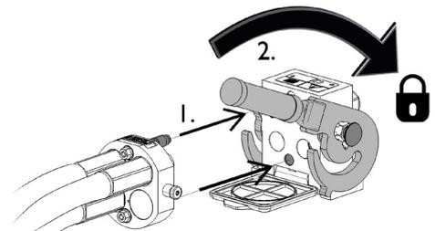
Le levier doit facilement se déplacer jusqu'à sa position de verrouillage. Si le levier ne coulisse pas correctement, vérifiez l'alignement et la position du connecteur et nettoyez les connecteurs. Arrêtez également le chargeur et relâchez la pression hydraulique résiduelle.
