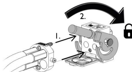
Le levier doit tourner légèrement jusqu'à la position verrouillée. Si cela n'est pas le cas, vérifiez l'alignement et position des multiconnecteurs de l'accessoire et du chargeur, et nettoyez les connecteurs. Arrêtez le moteur thermique et dépressurisez le système hydraulique.
