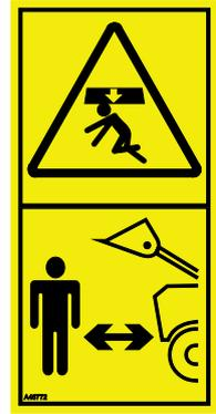
Gardez à l'esprit que le bras de levage peut être abaissé ou incliné, même si le moteur a été arrêté (risque d'écrasement). Le chargeur n'a pas été conçu pour maintenir une charge élevée pendant longtemps. Abaissez toujours l'accessoire à une position de sécurité avant de quitter le siège du conducteur.
