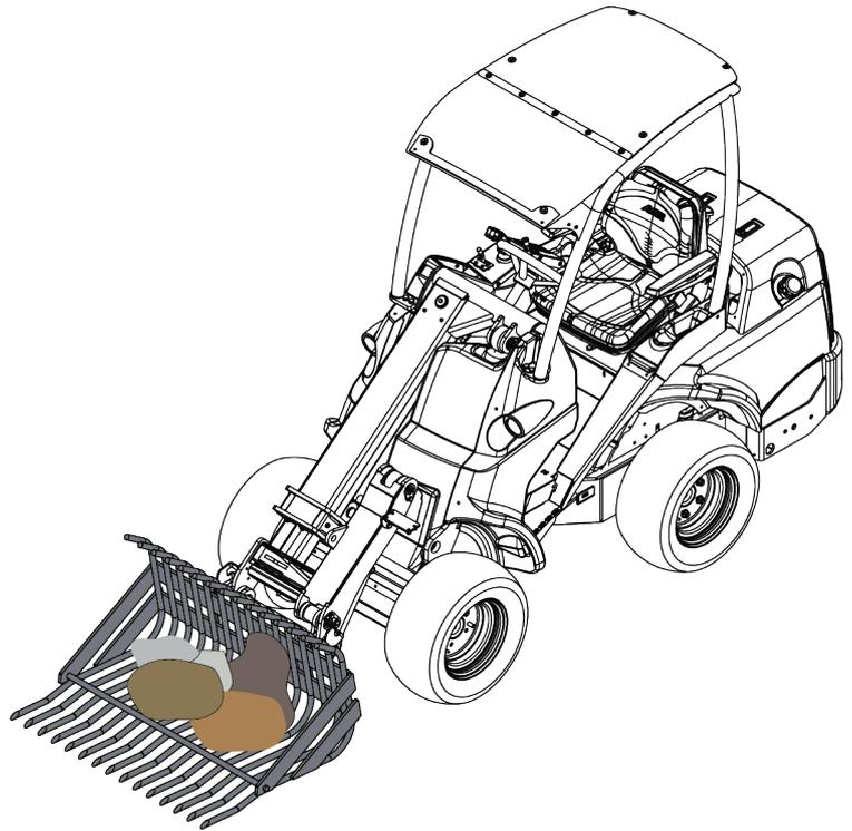
La manière la plus efficace de remplir un godet consiste à pousser juste la pointe du godet dans une pierre, puis la pierre se retrouve dans le godet par la conduite, le levage et l'inclinaison simultanés du godet, tel qu'illustré sur les figures suivantes. La même technique de base est également applicable lors de l'excavation d'une pierre du sol.
