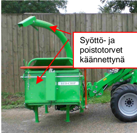
Kuva 5.6 Torvet valmiina kuljetusta varten (paitsi tukijalat)
