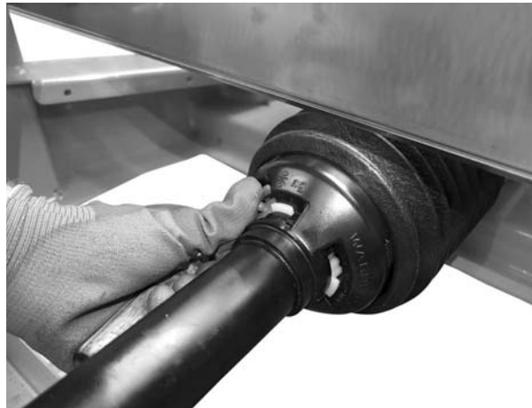
Kuva 6.5: Varmista nivelakselin suojuksen kiinnitys
