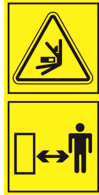
Estä varastoidun työlaitteen kaatuminen
