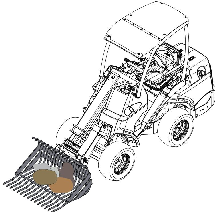
Kõige efektiivsem kopa täitmise viis on suruda kivi alla ainult kopa ots ja seejärel lükata kivi kopa sisse samaaegse söitmise ning kopa töstmise ja kallutamise teel. Sama põhitehnikat rakendatakse ka kivi kaevamisel maapinnast.
