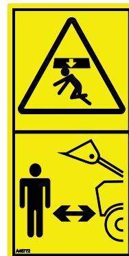
Pidage meeles, et laaduri noolt saab langetada või kallutada, isegi kui mootor on välja lülitatud (muljumisoht). Laadur ei ole mõeldud koorma pikaaegseks üleval hoidmiseks. Enne juhiistmelt lahkumist langetage töövahend alati ohutusse asendisse.
