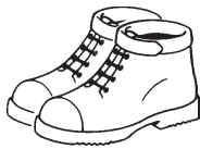
Calzado contra accidentes con puntera reforzada y suela antideslizante
