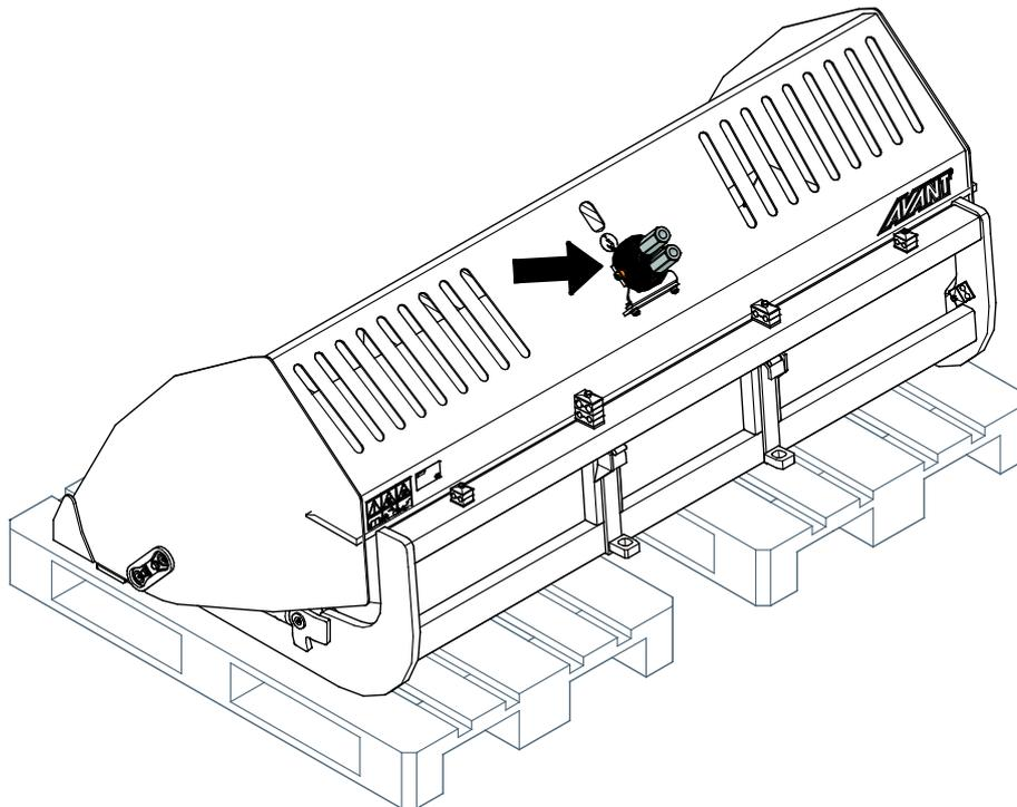
Antes de un almacenamiento prolongado, limpie el implemento, retoque la pintura donde sea necesario y aplique grasa a los puntos de engrase y aceite a las partes visibles de los ejes del cilindro hidráulico para evitar la corrosión.
