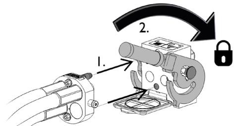
La palanca debería moverse con facilidad hasta su posición de bloqueo. Si no puede girar la palanca con facilidad, compruebe la alineación y posición del conector y la limpiezas de los conectores. Pare también la minicargadora y alivie la presión hidráulica residual.
