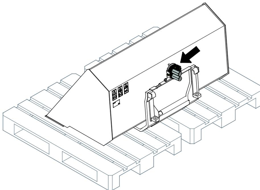
Antes de un almacenamiento prolongado, limpie el implemento, retoque la pintura donde sea necesario y aplique grasa a los puntos de engrase y aceite a las partes visibles del eje del cilindro hidráulico para evitar la corrosión.
