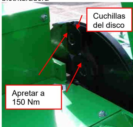
**⚠ ¡ATENCIÓN!** Las cuchillas del disco solo deben afilarse por la cara posterior y en una amoladora de banco. El afilado de la cara frontal alterará la separación ajustada de fábrica. No afile las cuchillas con un equipo portátil.
