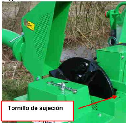
Fig. 6.7.2 Disco y cuchillas de la biotrituradora
