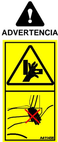
**Puntos de aplastamiento:** evite colocar las manos o los pies entre los bastidores delantero y trasero de la minicargadora o entre la minicargadora y una pared. Mantenga todas las partes del cuerpo dentro del chasis de seguridad. El movimiento del chasis articulado conlleva un riesgo de aplastamiento. Mantenga la cabeza, las manos y los pies dentro de la minicargadora. Tenga especial cuidado al aproximarse a muros y árboles. Mantenga las manos en el volante y en el joystick.
