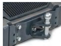
En acoplamiento a tráiler puede montarse o bien directamente en el parachoques trasero o bien en el contrapeso trasero adicional.
