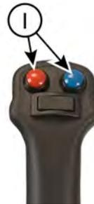
Presione y mantenga pulsado cualquier botón para ajustar la dirección del caudal de los hidráulicos auxiliares.
