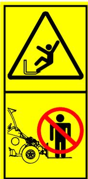
**Riesgo de caída desde una posición elevada y de atropello: nunca levante ni transporte personas.** Nunca use la minicargadora ni sus implementos para levantar ni transportar personas ni plataformas de trabajo de ningún tipo, ni tan siquiera momentáneamente. No se suba a la minicargadora o al implemento. La capacidad del asiento de la minicargadora es de una sola persona, independientemente del implemento.
