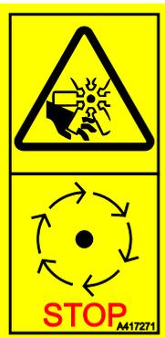
**Riesgo de contacto con componentes móviles: Pare siempre el motor antes de acceder al compartimento del motor.** El ventilador de refrigeración del motor, la correa del alternador y las poleas de la correa se moverán a gran velocidad cuando el motor esté en marcha. No abra nunca la tapa del motor con el motor en marcha.
