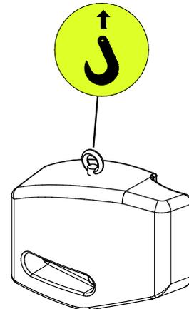
1. Instale una argolla de elevación en el agujero roscado de la parte superior del contrapeso. Vea la imagen que aparece a continuación.
