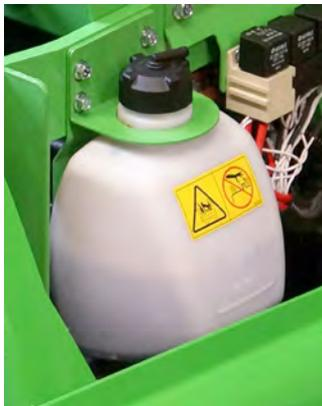
El sistema de refrigeración del motor utiliza un depósito presurizado. El nivel de refrigerante debería estar por encima de la marca mínima del depósito, y al menos 3 cm por debajo del tapón de llenado.
