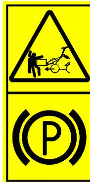
**Riesgo de atropello con la minicargadora: aplique el freno de estacionamiento antes de abandonar el asiento del operario.** Siga el procedimiento de parada segura para evitar cualquier movimiento de la minicargadora. Evite dejar la minicargadora estacionada en pendiente. Si no tiene otro remedio que aparcarla en pendiente, utilice calzos u otros medios adicionales para impedir que la minicargadora se ponga en movimiento.
