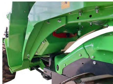
La barra de bloqueo está prevista para inmovilizar el chasis articulado manteniéndolo extendido durante el elevación o el transporte.
