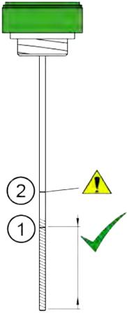
1. Marca objetivo. Rellene hasta esta marca con el sistema hidráulico en **frío**.
