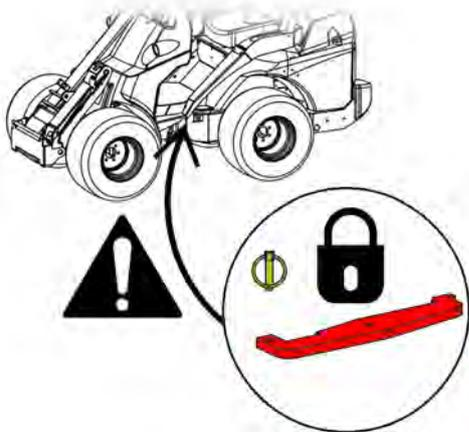
Antes de transportar o levantar la minicargadora, instale siempre la barra de unión del chasis. Recuerde igualmente quitar la barra de unión del chasis tras el transporte y comprobar el funcionamiento de la dirección la minicargadora.
