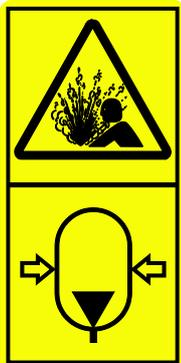
**Riesgo de quemadura con aceite hidráulico: aisle el acumulador hidráulico antes de iniciar cualquier mantenimiento.** Si la minicargadora está equipada con la función de conducción suave, el circuito hidráulico del brazo incorporará un acumulador de presión. No desconecte ningún componente hidráulico sin haber aislado antes el acumulador del circuito y liberado la presión residual.
