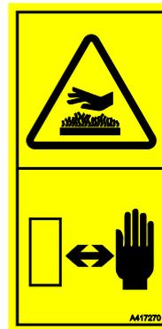
**Riesgo de quemaduras: deje que la minicargadora se enfríe antes de abrir las tapas.** Las piezas del motor, el sistema de escape y los componentes hidráulicos pueden estar muy calientes tras el uso.
