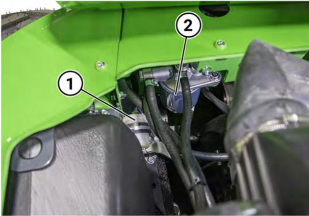
Una vez sustituido el filtro, cebe el sistema de combustible girando la llave de contacto de la minicargadora a la posición de encendido, pero sin arrancarla. Deje que la bomba eléctrica haga circular el combustible durante un par de minutos antes de arrancar.
