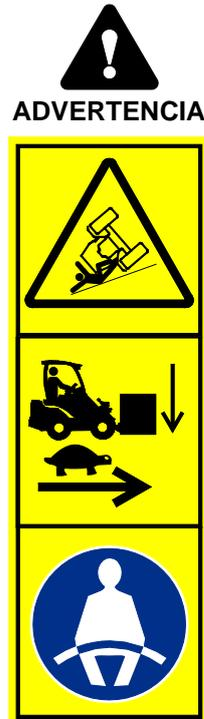
**Riesgo de vuelco sobre terrenos irregulares: Conduzca despacio sobre superficies inclinadas. Sitúe la carga siempre cerca del suelo. Lleve siempre abrochado el cinturón de seguridad para permanecer dentro de la estructura de protección en caso de vuelco.** Manipule las cargas pesadas únicamente sobre terreno firme y regular y con desplazamientos lentos.
