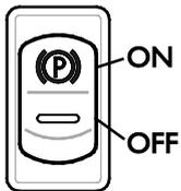
La minicargadora está equipada con un sistema de frenada que bloquea las ruedas traseras. El freno de estacionamiento se acciona con el interruptor del lado derecho del panel de control.
