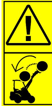
**Riesgo de lesiones graves o muerte por la caída de objetos.** Nunca incline el implemento hacia atrás cuando esté elevado a bastante altura. Utilice sólo máquinas equipadas con estructuras ROPS y FOPS. Asegure al implemento las cargas que puedan caerse. Use el tipo correcto de implemento con cada tipo de carga y siga los manuales del operario de los implementos.
