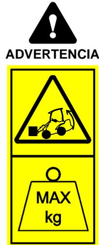
**Riesgo de vuelco: siga las instrucciones de seguridad.** La capacidad de elevación de la minicargadora está limitada por la posibilidad de vuelco sobre el eje delantero.
