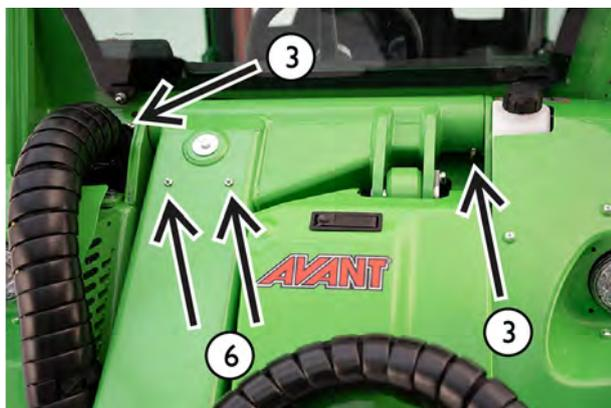
**C. Cilindros y placa de acoplamiento**
