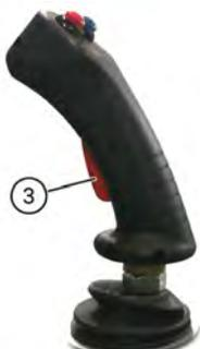
El botón opcional de la parte posterior del joystick (3) es el interruptor de control de la válvula antideslizamiento.
