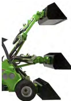
El sistema de autonivelación mantiene el implemento inclinado en la misma posición al levantar o bajar el brazo.
