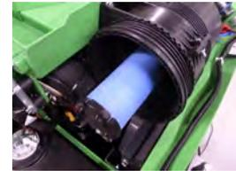
Sustituya el elemento filtrante del aire interno si observa suciedad o daños, o si cambia de color respecto al tono azul original. Sustituya también los dos elementos filtrantes del aire si el filtro de aire principal ha sufrido algún daño.
