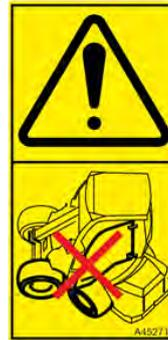
**Riesgo de rotura de lunas: no conduzca con la puerta de la cabina abierta.** La puerta podría romperse al contacto con las ruedas. Coloque también el chasis articulado en posición recta antes de abrir la puerta.
