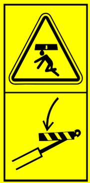
**Riesgo de aplastamiento. Caída de carga.** Asegure siempre el brazo de la minicargadora utilizando el soporte de mantenimiento proporcionado antes de meterse bajo el brazo de la minicargadora. Quite las fijaciones e implementos de la minicargadora antes de repararla o hacer su mantenimiento.
