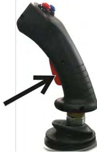
La válvula antideslizamiento se acciona manteniendo pulsado el interruptor del joystick.
