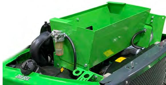
**Para comprobar si necesita drenar el separador de agua**
