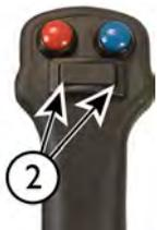
El brazo telescópico se puede controlar con el interruptor de palanca.
