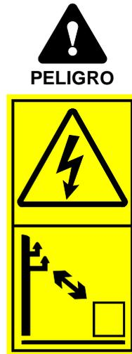
**Riesgo de electrocución. Manténgase alejado del tendido eléctrico.** El contacto con los cables eléctricos o trabajar demasiado cerca de ellos puede provocar una descarga eléctrica letal. Mantenga la minicargadora y cualquier implemento a suficiente distancia de todos los cables eléctricos (consulte la siguiente tabla). Nunca asuma que un cable está desconectado.
