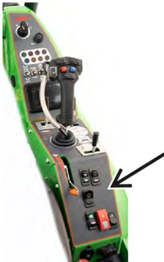
Todos los interruptores se encuentran junto a la palanca de aceleración
