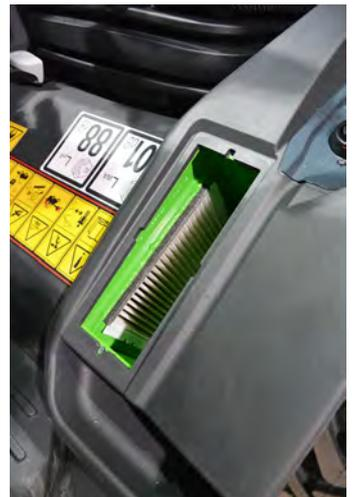
4. Mueva ligeramente el elemento filtrante hacia afuera y tire de él para sacarlo.
