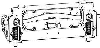
La placa de acoplamiento de implementos hidráulica opcional permite bloquear y desbloquear el implemento desde el asiento del operario.
