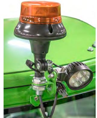
Manipule el girofaro con cuidado. El girofaro está sellado y sus componentes internos no los puede sustituir o reparar el usuario.
