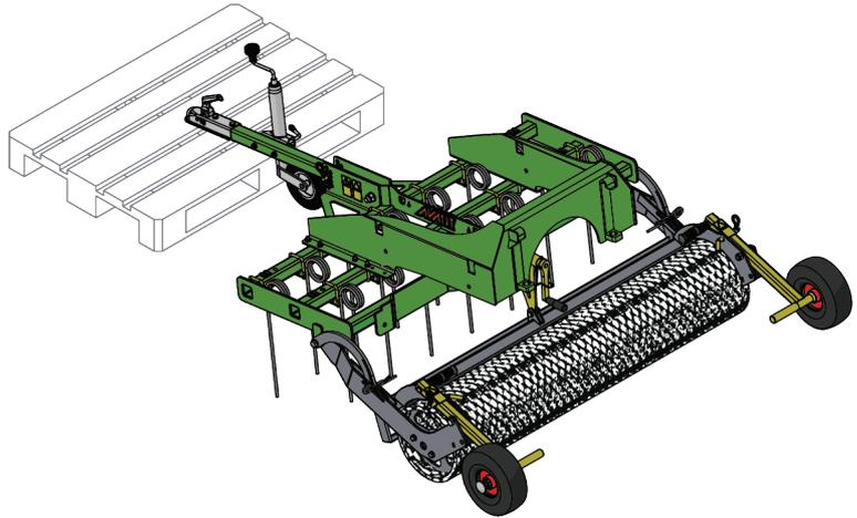
Vor der Einlagerung im Winter muss das Anbaugerät sorgfältig gereinigt und alle Reste entfernt werden. Bessern Sie im Bedarfsfall den Lack auf und schmieren Sie die Schmierstellen, um Rostschäden vorzubeugen.
