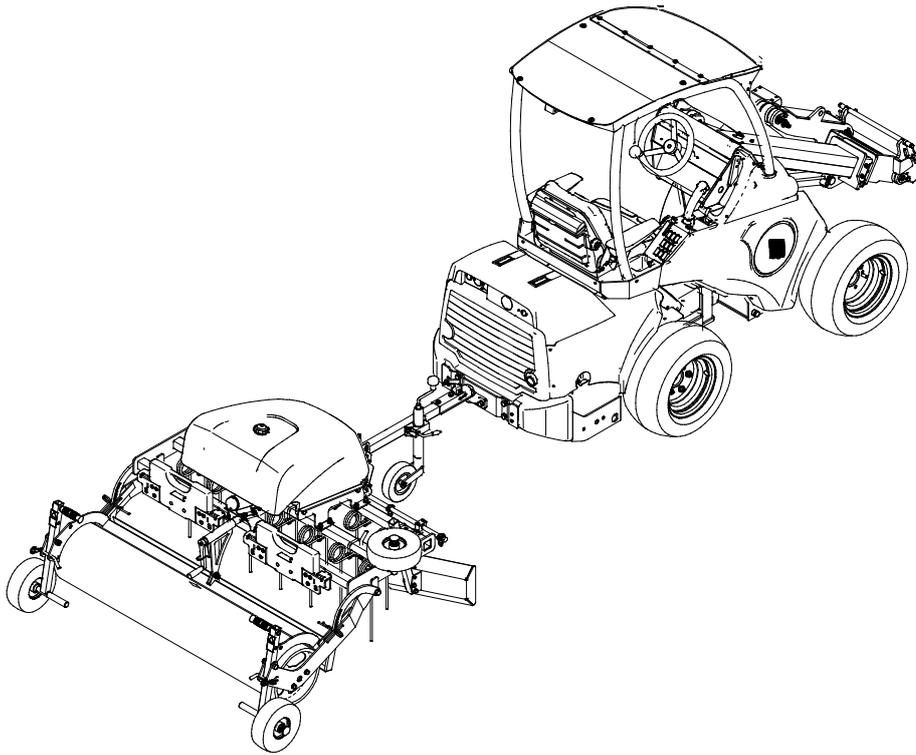
Wenn der Planer nicht mit Stützrädern ausgestattet ist, wird nicht empfohlen, den Planer über lange Strecken oder auf harten Oberflächen zu ziehen. Der Planer könnte beschädigt werden.
