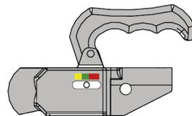
3. Stellen Sie das **Gleichgewicht zwischen der hinteren Walze und den Zinken ein**, indem Sie den Griff auf der Rückseite betätigen.
