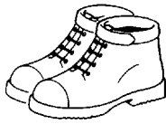
Unfallschutzschuhe mit rutschfester Sohle und verstärkter Fußspitze
