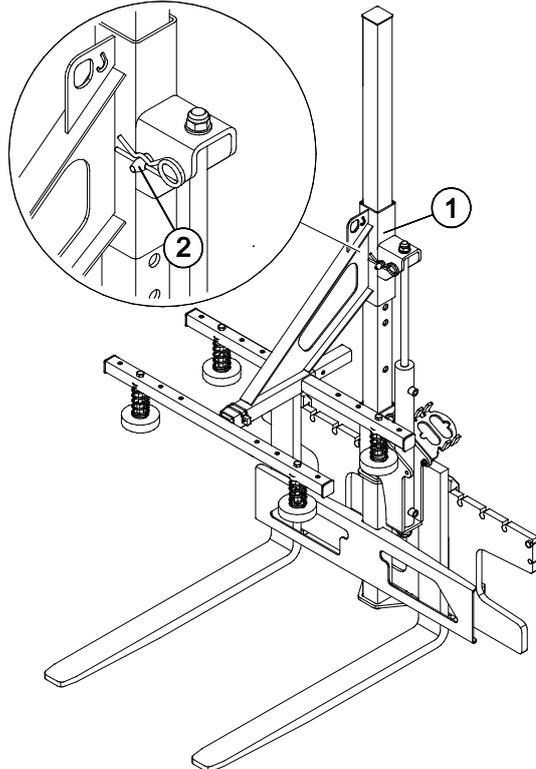
Setzen Sie den Verriegelungsbolzen in das Loch im Mast ein, wie in der nebenstehenden Abbildung gezeigt, und senken Sie den oberen Wagen auf den Bolzen.
