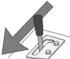
Bewegen Sie den Hebel von der Sperrposition zu Öffnen Sie den Greifer.
