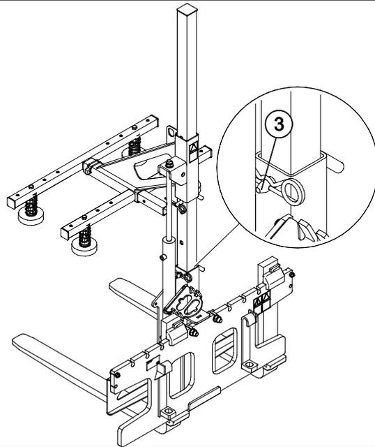
Fahren Sie zunächst den unteren Wagen nach oben. Verriegeln Sie anschließend den Wagen in der gewünschten Höhe mit dem Verriegelungsbolzen (3). Entfernen Sie schließlich den Verriegelungsbolzen (2) und setzen Sie ihn wieder in die Halterung ein.
