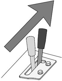
Bewegen Sie den Steuerhebel der Zusatzhydraulik in seine Sperrposition (oder verwenden Sie die elektrischen Tasten des optionalen elektrischen Joysticks), um Schließen Sie den Greifer.
