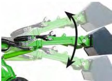
Le système stabilisateur de charge est une suspension du bras de levage. Lorsque l'on roule à une vitesse plus importante avec une charge ou un accessoire lourd, le bras commence à bouger de haut en bas, ce qui rend la translation désagréable. Le système consiste en un accumulateur hydraulique qui absorbe et amortit les mouvements du bras et fait la translation beaucoup plus stable et souple. La machine doit également être équipée du parallélogramme et la position flottante du bras de levage.
