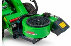
Le kit interrupteurs Opticontrol® (en option) est recommandé sur le chargeur, pour commander l'orientation électrique de l'aspirateur souffleur. Si le souffleur est équipé de réglage électrique de l'embout, l'Opticontrol® est nécessaire.
