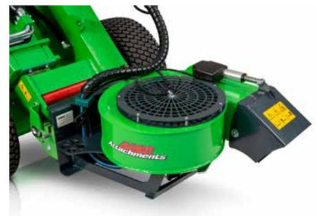
Für die elektr. Verstellung der Düse ist das optionale Opticontrol®-Schalterpaket erforderlich.
