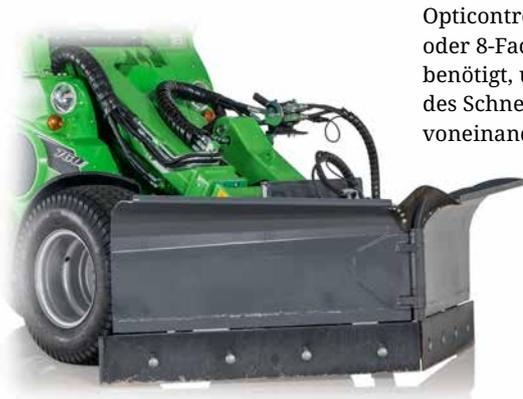
Opticontrol® (Option) sowie 6-fach oder 8-Fach Joystick werden benötigt, um die beiden Schilde des Schneepfluges unabhängig voneinander zu steuern.
