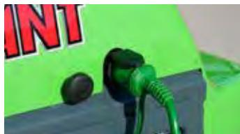
Riscaldatore supplementare motore
