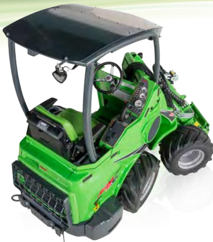
Avant serie R è diversa dall'Avant tradizionale in termini di sterzo: nella serie R l'operatore siede nel telaio posteriore sopra il motore, mentre negli altri modelli Avant articolati l'operatore siede nel telaio anteriore. Fatta eccezione per il sistema di sterzo, la serie R è simile agli altri modelli Avant e il loro design si basa sulle seguenti macchine:
