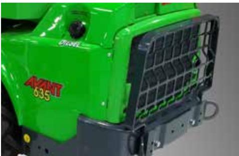
Der Heckschutz schützt Lüfter und Heck des Laders. Der Schutz wird an den Befestigungen im Heck montiert. Zurrösen sind in den Schutz bereits integriert und auch Anhängerkupplungen oder Heckgewicht können an einem mit Heckschutz ausgestattetem Lader montiert werden. Der Heckschutz kann je nach Bedarf schnell und einfach an- und abgebaut werden.
