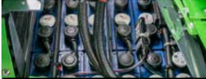
Komplettes Batteriepaket für Avant e5, AGM Batterien, 285 Ah, 48V.
