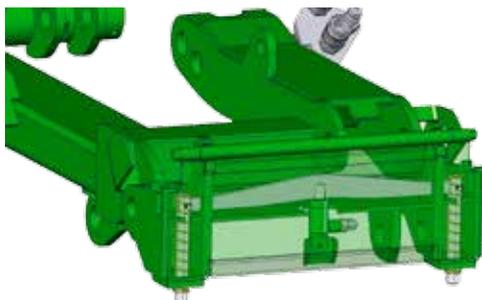
Mit der elektrohydraulischen Entriegelung können Anbaugeräte schnell und mühelos automatisch direkt vom Fahrersitz aus entriegelt werden. Die Verriegelungsbolzen werden vom Fahrersitz aus gesteuert und bewegen sich hydraulisch. So gelingt der Anbaugerätewechsel noch schneller.
