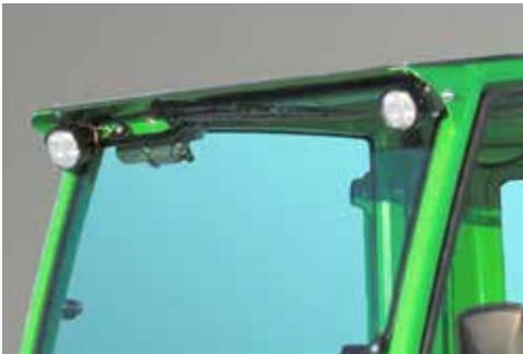
Die zusätzlichen LED-Arbeitsscheinwerfer ermöglichen den sicheren und effizienten Einsatz des Laders auch bei Dunkelheit und können auch an einer Leichtkabine LX montiert werden. Sie haben die Wahl zwischen LED-Scheinwerfern mit 700 Lumen oder 2500 Lumen. Die 3 Leuchten werden im Front- (2) und Heckbereich (1) montiert.
