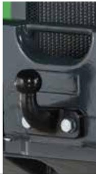
Es sind zwei Typen von Anhängerkupplungen erhältlich. Eine Anhängerkupplung mit 50 mm Kugelkopf und eine Anhängerkombikupplung mit 50 mm Kugelkopf und Zugmaul. Beide Anhängerkupplungen werden entweder direkt am Heckgewicht oder der Stoßstange montiert. Die AVANT 200 Serie ist serienmäßig mit einer 50 mm Kugelkopfkupplung ausgestattet.
