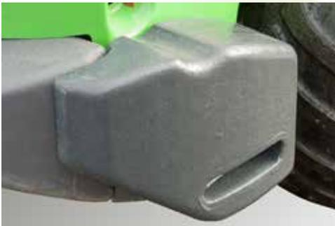
Das 180 kg Heck-Seitengewicht-Set besteht aus 2 je 90 kg schweren Heck-Seitengewichten, die rechts und links hinter den Hinterrädern des Laders montiert werden. Die Gewichte steigern Hubkraft und Stabilität beim Umgang mit schweren Lasten.
