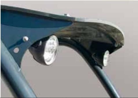
Die zusätzlichen LED-Arbeitsscheinwerfer ermöglichen den sicheren und effizienten Einsatz des Laders auch bei Dunkelheit. Sie haben die Wahl zwischen LED-Scheinwerfern mit 700 Lumen oder 2500 Lumen. Die 3 Leuchten werden im Front- (2) und Heckbereich (1) montiert.
