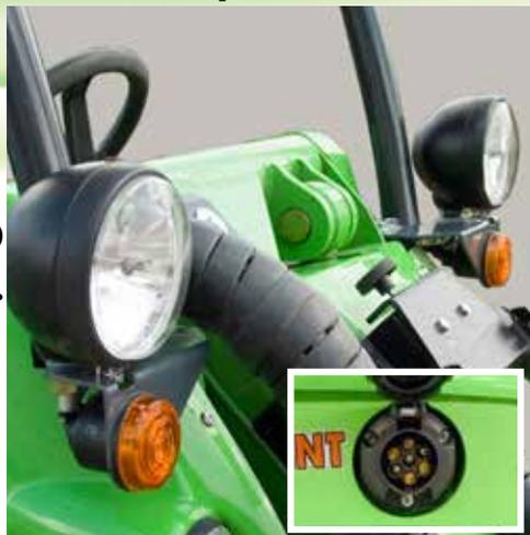
Das Paket beinhaltet Scheinwerfer, Blinker, Rundumleuchte, Reflektoren, einen Spiegel und das Warndreieck im Heck der Maschine. Das Kommunalpaket ist normalerweise eine Voraussetzung zur Erteilung einer Straßenzulassung, bitten nehmen Sie Kontakt mit Ihrem Avant-Händler.
