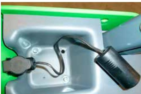
Anschlusskabel, montiert an der 12V-Steckdose der 300-700 Serie und 200 Serie(I). Ausgestattet mit einem Stecker, an dem ein Zigarettenanzünder angeschlossen werden kann, zum Beispiel bei der Verwendung eines Handy-Ladegerätes.
