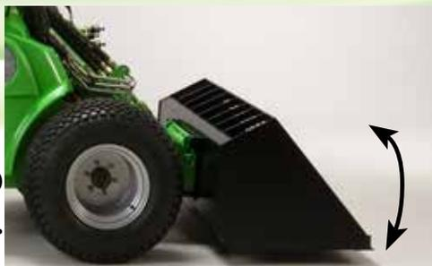
Auch Lader mit Parallelführung können mit dem Niveaueingleich ausgerüstet werden. Der Niveaueingleich umgeht die Parallelführung des Hubarmes, was bedeutet, dass die Parallelführung des Hubarmes ohne Funktion ist, wenn der Niveaueingleich eingeschaltet ist.
