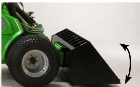
Der Niveaueingleich sorgt für freie Beweglichkeit der Anbaugeräte, die damit den Bodenkonturen folgen - besonders hilfreich bei der Arbeit mit Schaufel oder Schneeschild. Der Niveaueingleich wird per Schalter im Armaturenbrett ein- und ausgeschaltet.
