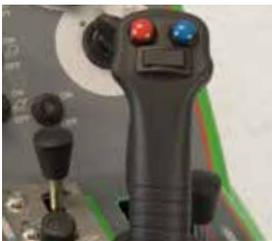
Mit der 8-fach Funktion kann neben der Zusatzhydraulik auch der Teleskophubarm mit den Schaltern auf dem Joystick gesteuert werden. So werden sowohl Ladarbeiten als auch Arbeiten mit hydraulischen Anbaugeräten wesentlich schneller durchgeführt.
