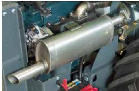
Der Abgas-Katalysator ersetzt den Originalschalldämpfer und ist Katalysator, Schalldämpfer und Funkenfänger in einem.
