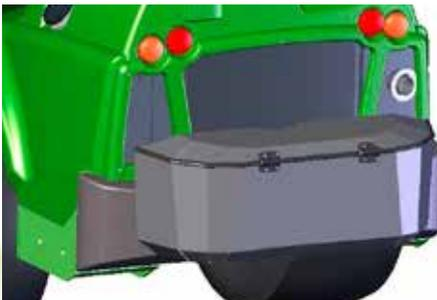
Box für Aufbewahrung und Transport von Werkzeug, Ausrüstung etc., die auf die Stoßstange im Heck der Maschine aufgeschraubt ist. Der Deckel kann bei Bedarf abgeschlossen werden.
