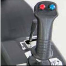
Mit dem 6-fach Joystick können hydraulisch betriebene Anbaugeräte mit zwei Knöpfen am Joystick gesteuert werden. So arbeiten Sie komfortabler und schneller, ohne die Bedienhebel wechseln zu müssen. Gleichzeitig können Hubarm und Geräteanbauplatte bedient werden.
