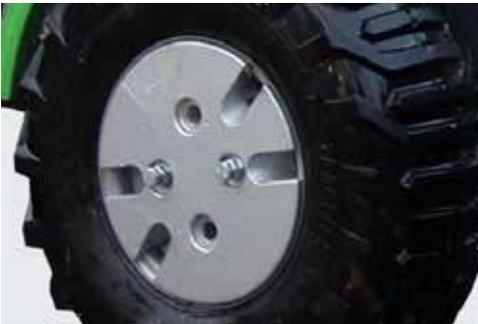
Die AVANT 200 Serie kann mit 14 kg schweren Radgewichten ausgerüstet werden, die mit speziellen Bolzen an der Felge montiert werden. Sie halten den Schwerpunkt des Laders tief und erhöhen die Stabilität besonders in unebenem Terrain oder in Waldgebieten.
