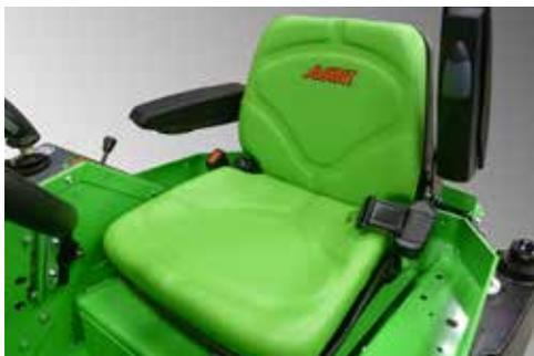
Der gefederte Sitz ist optional für die AVANT 200- und 400 Serie erhältlich und ausgestattet mit Armlehnen, Sicherheitsgurt und Sitzheizung.
