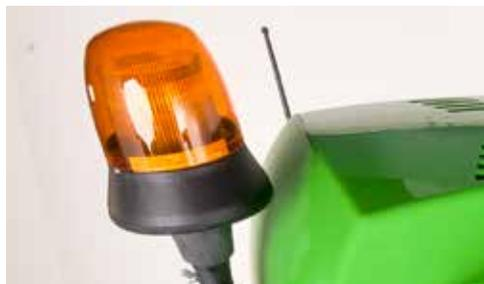
Die Rundumleuchte ist mit einer sehr hellen Xenon-Lampe ausgestattet. Sie wird auf einem kippbaren Sockel installiert und ist leicht an- und abzubauen.
