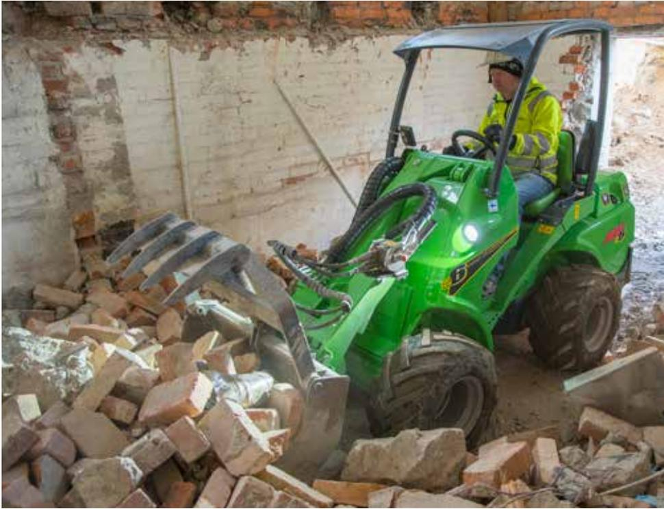
Avant e5 et e6 sont des chargeurs articulés électriques 100 %, alimentés par batterie. Ils peuvent être utilisés à l'intérieur et aux espaces sans ventilation également, où les moteurs à combustion sont interdits, quand il y a des limitations du niveau sonore etc.
