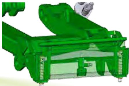
La platine d'accrochage hydraulique permet de coupler et détacher l'accessoire depuis le poste de conduite. Il y a un vérin hydraulique monté sur la platine d'accrochage qui fait lever et descendre les deux boulons de fixation. Le système électro-hydraulique fonctionne aussi quand le moteur n'est pas en marche, la clé de contact doit juste être en position ON (courant couplé).
