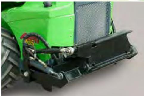
Le dispositif de levage hydraulique permet de monter certains accessoires à l'arrière de la machine: un distributeur du sel ou une fraise rotative par exemple. Cela veut dire également qu'un godet ou une lame de nivellement peut être montée à l'avant en même temps. Le dispositif de levage est équipé d'une prise hydraulique double effet et une position flottante.
