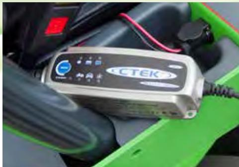
Vous pouvez charger la batterie très facilement en branchant le chargeur de batterie sur la prise de courant 12V de la machine – il n'y a pas besoin d'enlever les capots et brancher les fils du chargeur sur la batterie même. Le fonctionnement du chargeur est entièrement automatique: il change automatiquement du mode charge au mode entretien. Le chargeur est équipé de pinces également – vous pouvez donc charger autres batteries aussi.
