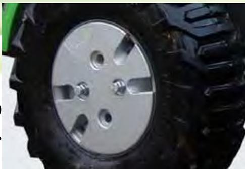
Avant série 200 peut être équipée de masses de roue à 14 kg qui se montent sur la jante avec des boulons spéciaux. Les masses rendent plus bas le centre de gravité de la machine, ce qui améliore la stabilité de la machine.
