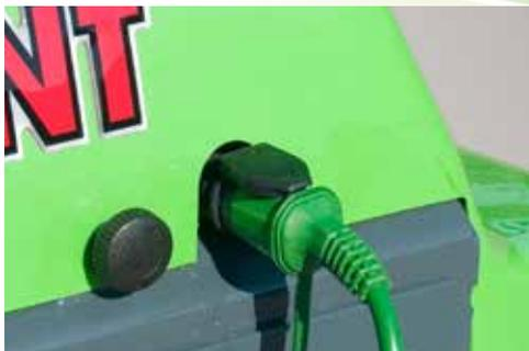
Le système de préchauffage électrique (220V) du moteur thermique est disponible pour faciliter le démarrage quand la température ambiante est en dessous de zero.
