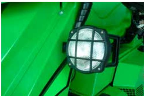
Sur la série 300 le phare de travail optionnel se monte du côté gauche du châssis avant.
