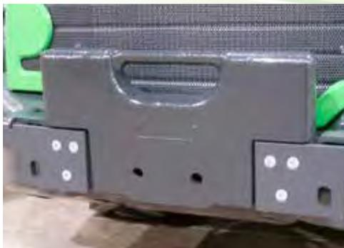
La masse arrière supplémentaire de 29 kg se monte à l'arrière de la machine. Elle est équipée de poignet et deux crochets donc elle est facile à monter sur le pare-choc arrière, et il est possible d'assembler plusieurs masses entre elles également. Les boules d'attelage réf. A417323 et A417337 peuvent aussi être montés sur la masse arrière.
