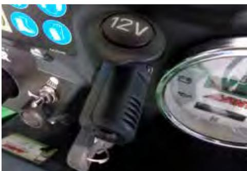
Le connecteur peut être monté sur la prise 12V des séries 300-700 et sur la prise 12V plus importante de la 200 série 2. On peut brancher les fils d'un appareil électrique 12V (un chargeur de batterie par exemple) sur ce connecteur. Les compétences d'un électricien sont donc nécessaires.
