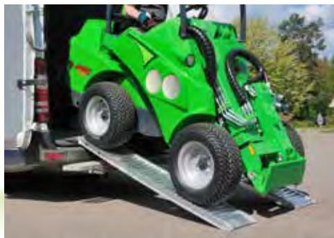
Les rampes légères et durables en aluminium sont faciles à manier et à nettoyer grâce à la surface crénelée et antidérapante.
