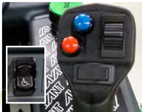
Le système de commande à la main permet la translation avant-arrière du chargeur par un interrupteur sur la manette joystick, au lieu des pédales de marche. La commande à la main est proportionnelle comme les pédales: plus l'interrupteur est tourné plus vite la machine va avancer. Il est possible d'utiliser soit la commande à la main soit les pédales de marche. L'interrupteur de sélection commande à la main/pédales se trouve dans le tableau de bord.
