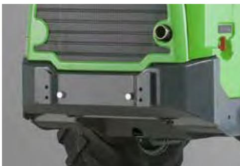
Avant série 500 et 600 sont équipées d'un pare-choc arrière de 170 kg en standard, mais si une machine plus légère est nécessaire – pour travaux dans les endroits avec capacité de charge limitée par exemple – un pare-choc léger peut être monté au lieu du pare-choc standard. Il réduit le poids hors tout de la machine par d'environ 150 kg.
