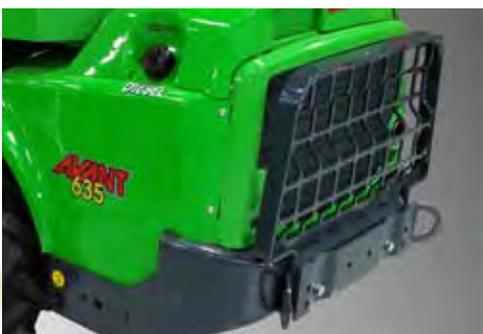
La grille protège l'arrière et le radiateur du moteur thermique – et la batterie des e5 et e6. Elle est montée avec quatre boulons et est facile à installer et enlever. La grille est équipée d'oeillets d'attelage et permet de monter les masses arrière et/ou le crochet d'attelage également.
