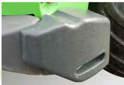
Les masses latérales se montent derrière les roues arrière. Elles sont livrées en kit de 2 masses: droite et gauche. Le poids du kit est de 180 kg.
