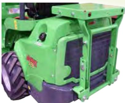
Le plateau de montage pivotant monte sur le pare-choc arrière avec boulons. Il est une équipement standard pour le montage arrière de la groupe électrogène, le compresseur et le nettoyeur à pression.
