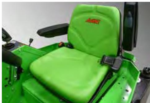
Le siège à suspension est un équipement optionnel sur les séries 200 et 400. Le siège est équipé d'une ceinture de sécurité, appuis-bras et chauffage.
