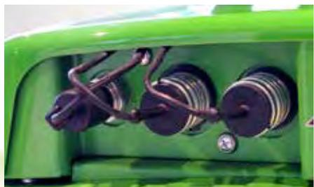
La prise arrière double effet est équipée des lignes de pression et retour (series 400-700 avec une ligne de retour libre également) et permet d'utiliser des accessoires hydrauliques comme remorque hydraulique, distributeur de sable etc. à l'arrière.
