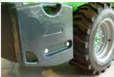
Les masses latérales se montent derrière les roues arrière. Elles sont livrées en kit de 2 masses: droite et gauche. Le poids du kit est de 80 kg et les masses sont destinées plutôt à la série 400 mais peuvent être montées sur les modèles d'Avant plus importants également.
