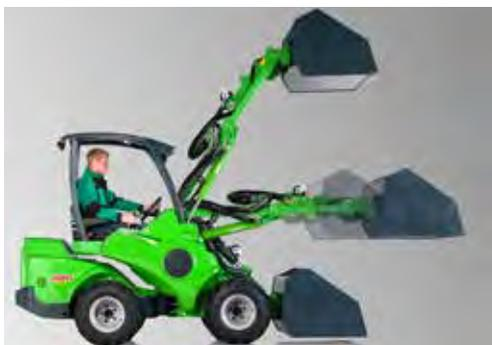
Le parallélogramme maintient la position horizontale de l'accessoire lorsque l'on fait lever ou descendre le bras de levage. Le système est hydraulique: il y a le vérin de parallélogramme qui se trouve à gauche du bras de levage et suit les mouvements du vérin de cage, en maintenant la position de l'accessoire. Le vérin donne plus de force de levage également.
