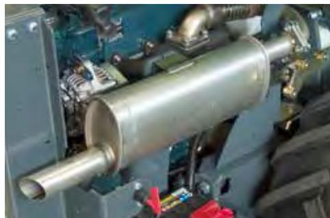
Le pot catalytique peut être monté au lieu du pot d'échappement standard. Il réduit les émissions du moteur diesel.
