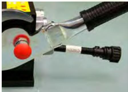
Les chargeurs Avant fabriqués avant 2016, où la prise électrique n'est pas montée sur le multiconnecteur, peuvent être mis à jour avec un fil électrique depuis le kit interrupteurs est monté sur cet adaptateur. L'accessoire peut également être équipé d'un fil adaptateur correspondant si nécessaire. Avec ce fil adaptateur les flexibles hydrauliques et le fil électrique de l'accessoire sont couplés en même temps par le multiconnecteur.
