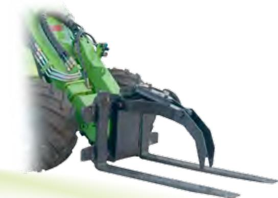
En France, lors de l'utilisation de la pince à bois, le chargeur doit être équipé d'un toit de sécurité FOPS.
