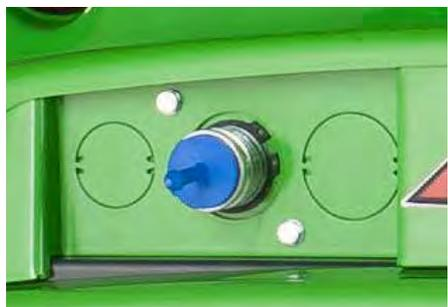
La prise arrière simple effet est équipée d'une ligne de pression et permet d'utiliser des accessoires avec fonctionnement hydraulique simple effet.
