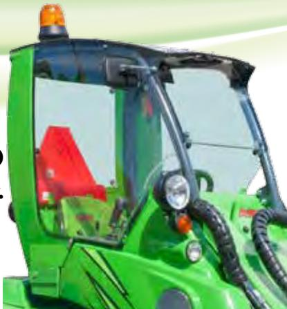
AVANT cabine L est un choix excellent et économique dans les situations où l'opérateur doit être protégé contre la pluie, le vent et la neige. La cabine L améliore le confort et les conditions de travail d'une façon importante. La cabine L se monte sur l'arceau ROPS/FOPS standard. Elle est composée d'un pare-brise (avec lave glace et essuie glace), de la vitre droite et de la vitre arrière. Pour Avant série 200, une porte est disponible sur la cabine L.
