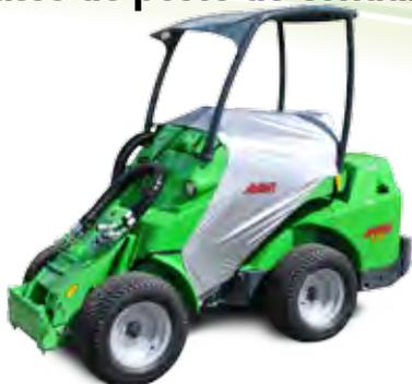
La housse protège le poste de conduit contre la pluie, neige et poussière. Le tissu imperméable couvre le tableau de bord, le volant et le siege. La housse est livrée avec une pochette où elle peut être conservée.
