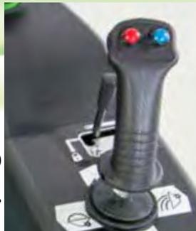
Les accessoires hydrauliques peuvent être commandés par les interrupteurs dans la manette joystick. Cela facilite l'opération des accessoires et le travail est beaucoup plus rapide, parce qu'on n'a pas besoin de déplacer la main de la manette lors d'opération, et il est possible de commander le bras de levage en même temps si nécessaire.
