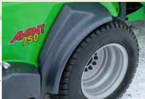
Les garde-boues arrière sont disponibles en option pour une nouvelle machine, ils ne peuvent pas être montés plus tard.
