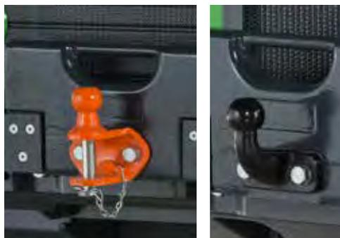
Il y a deux types de crochets d'attelage disponibles: une boule d'attelage de 50 mm et une boule de 50 mm avec axe d'attelage. Toutes les deux peuvent être montées soit sur le pare-choc arrière soit sur la masse arrière. Avant série 200 est équipée d'une boule de 50 mm en standard.
